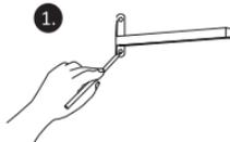
Mida y marque la altura del primer soporte donde va a quedar instalada la repisa, la medida se toma desde el piso hasta la altura deseada.
