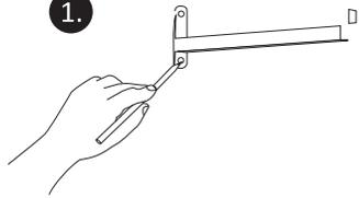
Mida y marque la altura del primer soporte donde va quedar instalada la repisa, la medida se toma desde el piso hasta la altura deseada.
