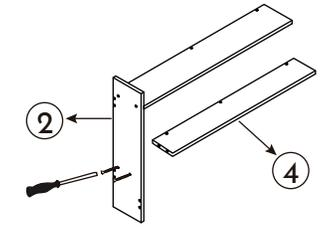
**3.-** Con los tornillos drywall 8x1 1/4" atornille el Lateral (2) al Paral (5).
